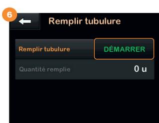
Maintenez la pompe verticale pour évacuer l'air qui pourrait se trouver dans le réservoir. Appuyez sur **DÉMARRER**. La pompe émettra un signal sonore et vibrera régulièrement pendant le remplissage.
