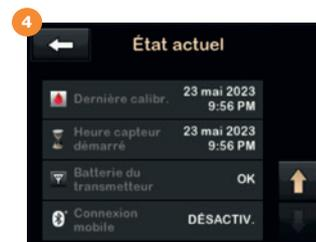
Appuyez sur la flèche vers le bas pour afficher la date de la dernière calibration, la date du démarrage du capteur, l'état de la batterie du transmetteur et l'état de la connexion mobile.
