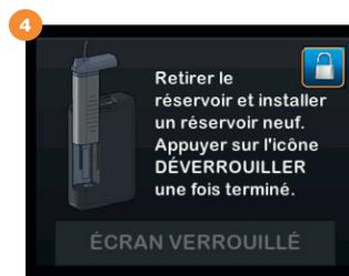
Retirez le réservoir usagé. Installez le nouveau réservoir rempli. Appuyez sur l'icône de déverrouillage lorsque vous avez terminé. Appuyez sur l'icône bleu et sur pour continuer.
